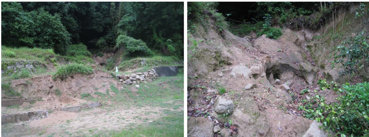
浅層崩壊跡。崩壊地の中央にパイピング孔がみられる。(撮影:広島市安佐北区)
